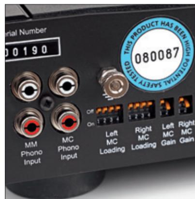
Hertz bis 100 Kilohertz, für MC 70 Hertz bis 70 Kilohertz. Die Eingangsimpedanz wird mit 70, 150, 100 oder 400 Ohm dem jeweiligen MC-System angepasst, die Lastkapazität ist mit 1.000, 2.000, 3.200 und 4.200 Pikofarad variierbar. Und wenn es gar zu leise ist, können nochmals 6 dB Verstärkung draufgepackt werden. Damit dürfte man den allermeisten Tonabnehmern gerecht werden.
